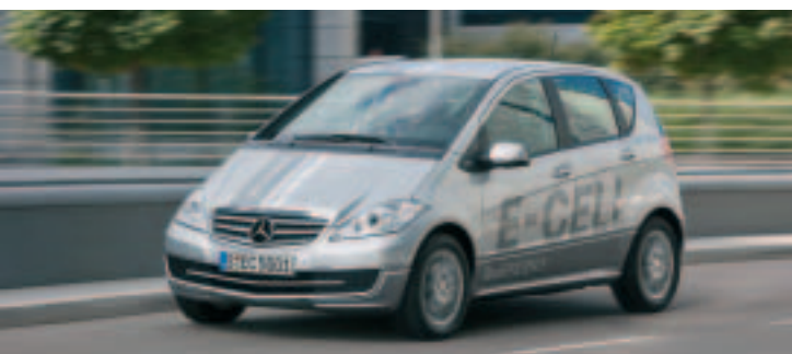
A-SARJA E-CELL 95 hv, 290 Nm, 0–60 km/h 5,5 s, toimintasäde yli 200 km
