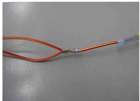
Esimerkki: Y-putki jossa kutisteliitin – lopuksi tiivistys kutistesukalla
