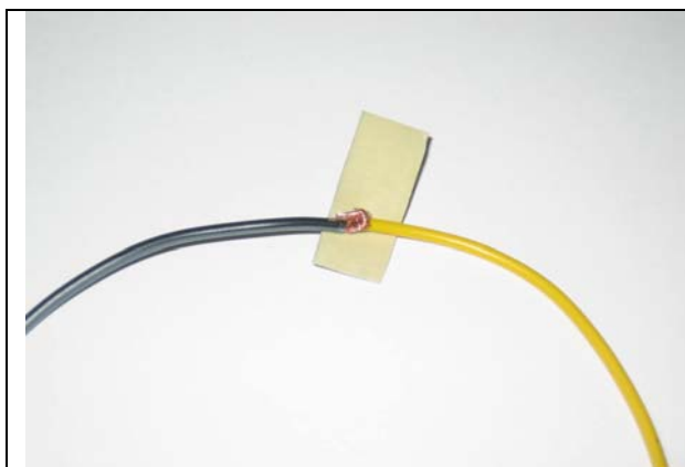
Yksinkertainen kiertäminen ja suojaus eristysnauhalla
