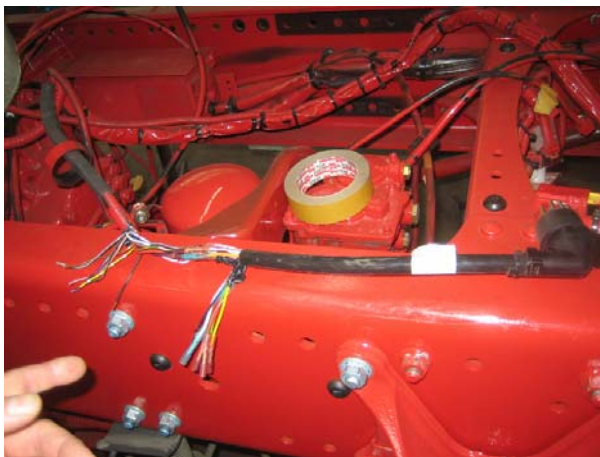
Johtosarjaa on jatkettu osittain esivalmistetun johdon avulla – siksi välipistoke
