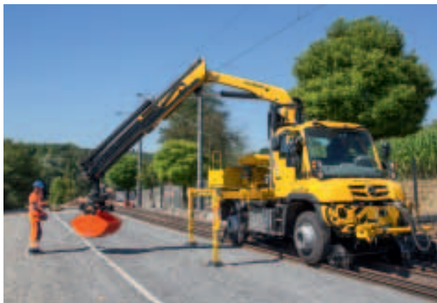
Monikäyttöinen kiskoajoneuvo työskentelyyn infrastruktuurin parissa sekä vaunujen vetämiseen.
