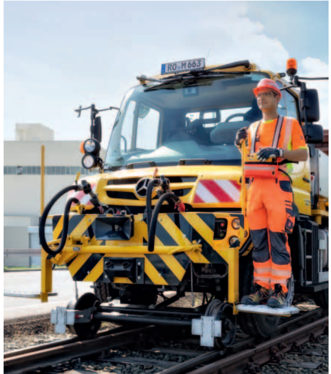
Ensin vaunun kytkeminen, sen jälkeen vaihtotehtäviin: radiokauko-ohjaimen ansiosta vaunuyhdistelmää voi ohjata yksin vetoajoneuvon luota
