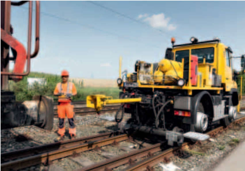
Vaunujen kytkeminen on tehty helpoksi. Vetolaitteita on saatavissa useina eri malleina
