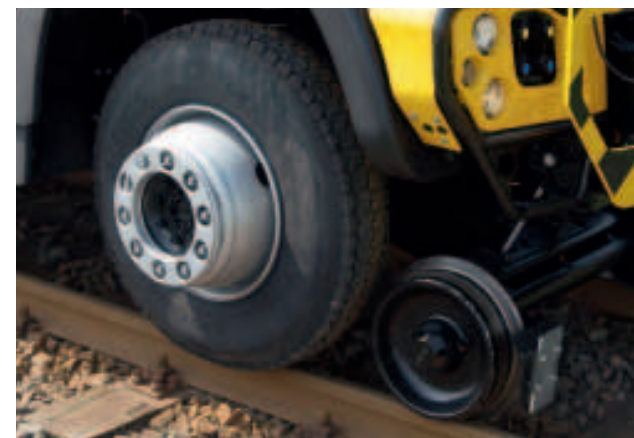
Vahva veto: käyttövoima välitetään Unimogin pyörien välityksellä – näin Unimog liikuttaa jopa 1 000 tonnin vaunukuormaa
