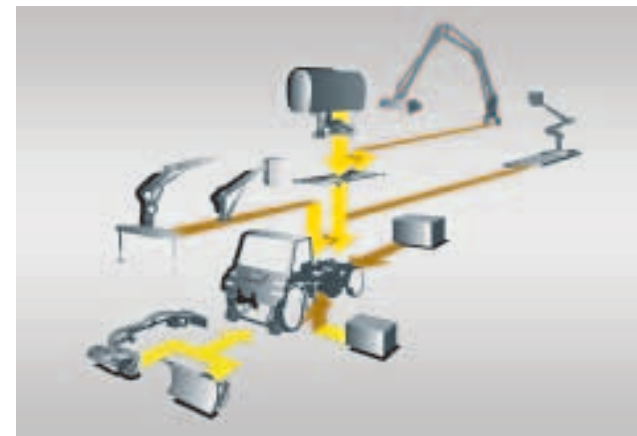
Lukuisat vaihtoehdot: jopa neljä paikkaa lisä- ja päällirakenteille
