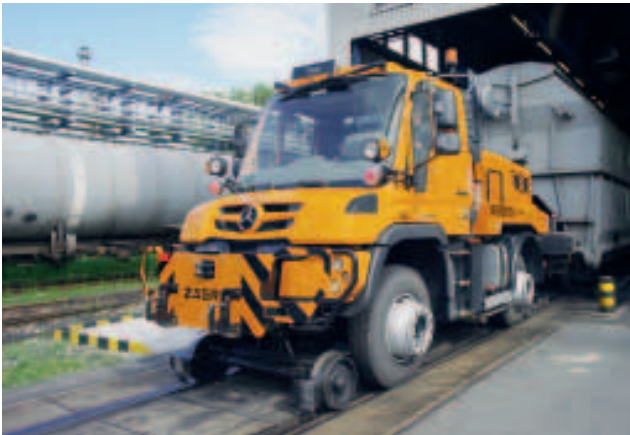
Jopa 1 000 tonnin vaunuorma: Unimog vaihtoveturitehtävässä
