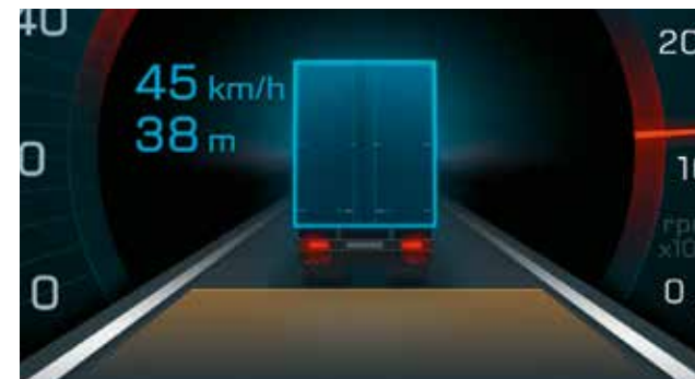
Etäisyysvalvonta 7) . Stop-and-go-toiminnon sisältävä ajoavustinjärjestelmä voi tukea kuljettajaa tietyissä tilanteissa ja minimoida peräänajokolarin vaaran.
