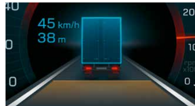
Etäisyysvalvonta 1) 12) . Stop-and-go-toiminnon sisältävä ajoavustinjärjestelmä voi tukea kuljettajaa tietyissä tilanteissa ja minimoida peräänajokolarien vaaran.
