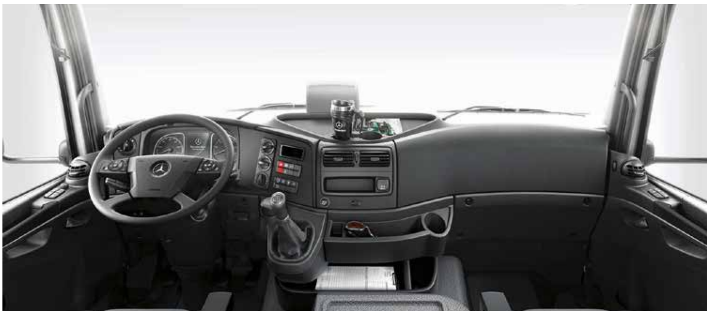
Klassinen kojetaulu. Ategon Classic-kojetaulu lukuisine säilytystiloineen sopii erinomaisesti maansiirtoajoon. Kaikki on sijoitettu ergonomisesti kuljettajan käden ulottuville.
