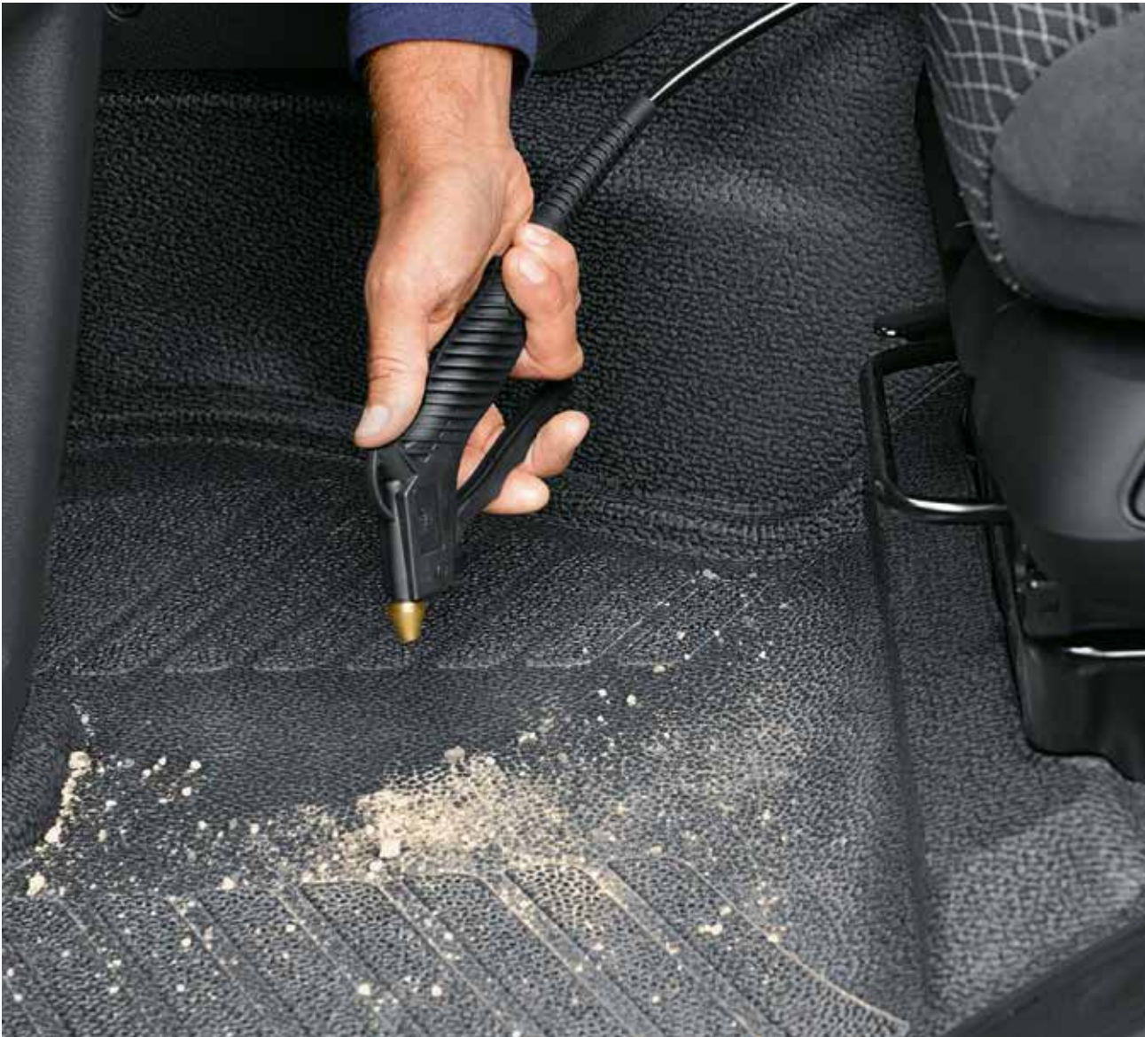
Paineilmapistooli. Paineilmapistooli, jossa on kierreletku, on hyödyllinen ohjaamoa puhdistettaessa.
